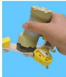
Jeweils ein Magnet wird in die Sockelplatte und den Justiersockel eingelegt. Um einer Beschädigung der Montageplatte oder des Magneten vorzubeugen, sollte ein Magnetheber verwendet werden.
