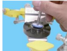
Achtung! Um ein unachtsames Öffnen nach dem Gleichschalten zu verhindern, sollten die Befestigungsschrauben fest angezogen werden. Das Öffnen der Halteschrauben nach dem Gleichschalten verändert in der Regel eine erneute Justierung mit dem Normkontrollsockel.
