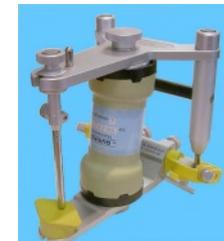
In der Zeit die das Kaltpolymerisat benötigt um auszuhärten, den Artikulator nicht mehr bewegen oder dessen Position verändern. Nach dem Aushärten der drei Fixierungspunkte wird noch der Zwischenraum des Justiersockels gefüllt.
